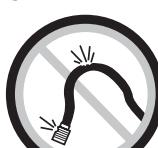
de látigo pueden ocasionar heridas serias. Siempre revise las mangueras y herrajes por daños, deshilachadas o solturas, y si es necesario, repóngalos inmediatamente. No opere ninguna herramienta dañada ni deteriorada. No use los acoplamientos de separación rápida con la herramienta. Vea las instrucciones para la instalación correcta.
