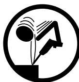
Mantengase alejado de la extremidad giratoria de la herramienta. No lleve joyas o ropa holgada. Fije el pelo largo. El escalpar puede ocurrir si el pelo no se mantiene lejos de la herramienta y accesorios. La asfixia puede ocurrir si los collares no se mantienen lejos de la herramienta y los accesorios.
