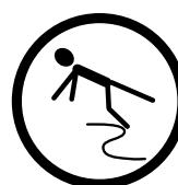
Un deslizamiento, una zancadilla y/o una caída durante el funcionamiento de las herramientas con aire pueden ser causas importantes de lesiones graves o de la muerte. Asegúrese que no haya un excedente de manguera sobre la superficie donde esté caminando o trabajando.
