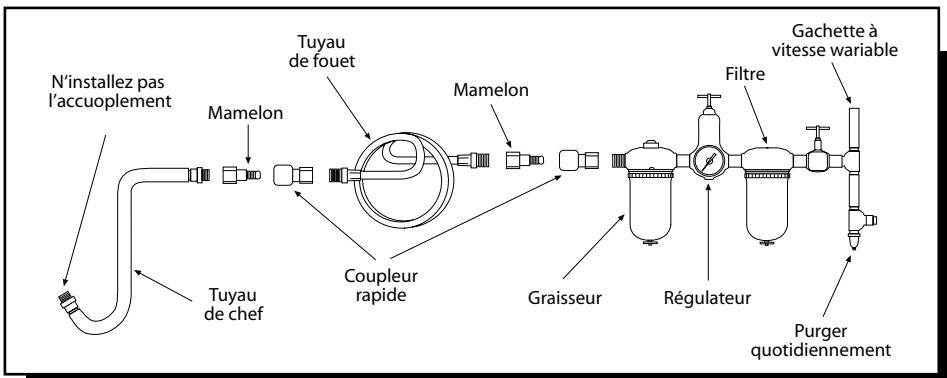
Les outils de cette catégorie fonctionnent avec un large éventail de pressions d'air. Nous recommandons une pression d'air à l'entrée de 90 lb/po<sup>2</sup>. Une faible pression (moins de 90 lb/po<sup>2</sup> ou de 6,2 bar) réduit la vitesse et le rendement de tous les outils pneumatiques. Une pression élevée (plus de 90 lib/po<sup>2</sup> ou 6,2 bar) excédant la puissance nominale de l'outil raccourcit sa durée de vie et peut causer des blessures.
