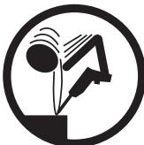
• La tige de l'outil peut continuer à tourner brièvement après le relâchement de la détente. Évitez tout contact direct avec les accessoires pendant ou après l'utilisation. Le port de gants réduit les risques de coupures ou de brûlures.
