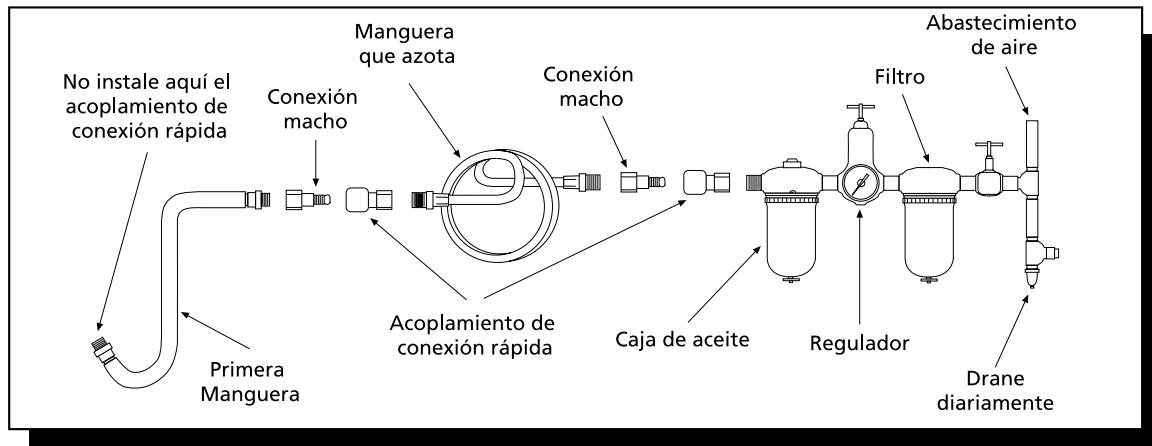
Las herramientas de esta categoría operan dentro de un rango amplio de presión de aire. Al trabajar libremente, se recomienda que la presión de aire de estas herramientas mida a un 90 psig en la herramienta. La presión alta y el aire sucio disminuirán la vida de la herramienta debido al desgaste más rápido, y pueden crear condiciones peligrosas.
