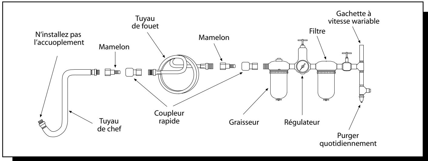
Cet outil peut fonctionner à l'intérieur d'une large plage de pression d'air. Il est recommandé que la pression soit de 90 psig lorsque la détente est totalement enfoncée et qu'aucune charge n'est imposée à l'outil. Une pression supérieure (plus de 90 psig; 6,2 bar) augmente la performance au-delà de la capacité nominale de l'outil, raccourcissant cependant ainsi la durée de vie de l'outil et pouvant donner lieu à des blessures.
