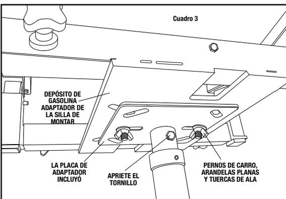
**TIPO 3** - Para algunos gatos se tendrán que extraer sus sillas estándares. Éstas tendrán que ser repuestas con la placa de adaptador #10 incluida con el adaptador de silla. La placa de adaptador está sujeta al pistón del gato al apretar el tornillo #9 en la base de placa del adaptador. Ver la figura 3. Siga las instrucciones de ensamble para los gatos TIPO 2 para sujetar el adaptador de la silla a la placa del adaptador.
