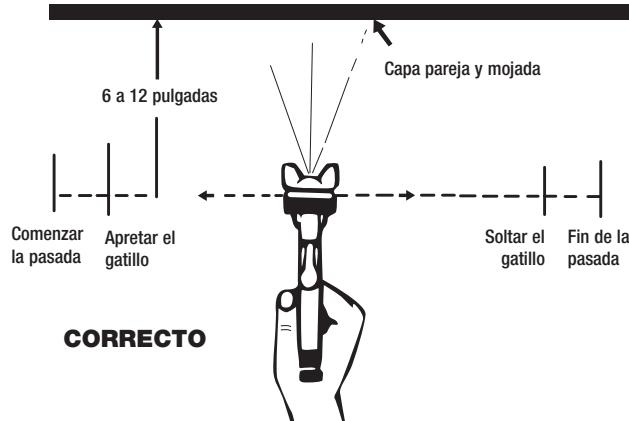
Sostenga la pistola de 6 a 12 pulgadas de distancia de la superficie, según el material que se use y la presión de atomización. Para obtener un acabado uniforme, traslape cada pasada sobre la pasada precedente, asegurándose de que el rociado salga suave y mojado.
