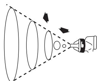
Le jet de pulvérisation peut être réglé à l'infini d'un jet rond à un jet plat
