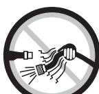
plan pourrait causer des blessures. Les tuyaux souples peuvent causer de graves blessures. Vérifiez toujours les boyaux et les raccords et remplacez-les s'ils sont endommagés, fissurés ou lâches. Évitez d'utiliser un outil endommagé ou usé. Évitez d'utiliser des raccords rapides avec cet outil. Pour installer correctement l'outil, consulter les directives.
