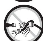
podría ocasionar alguna lesión. Las mangueras de látigo pueden ocasionar heridas serias. Siempre revise las mangueras y herrajes por daños, deshilachadas o solturas, y si es necesario, repóngalos inmediatamente. No opere ninguna herramienta dañada ni deteriorada. No use los acoplamientos de separación rápida con la herramienta. Vea las instrucciones para la instalación correcta.
