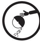
Coloque el guardarrueda entre la rueda de amolar y el operador. Use barreras para proteger a los demás de los fragmentos de rueda y las chispas producidas por la amoladura.
