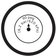
Pour des raisons de sécurité, de performance et de durabilité maximale des pièces, utiliser cet outil à une pression d'air maximale de 6,2 bars / 90 psig, avec un flexible d'alimentation d'air de 3/8 po de diamètre.
